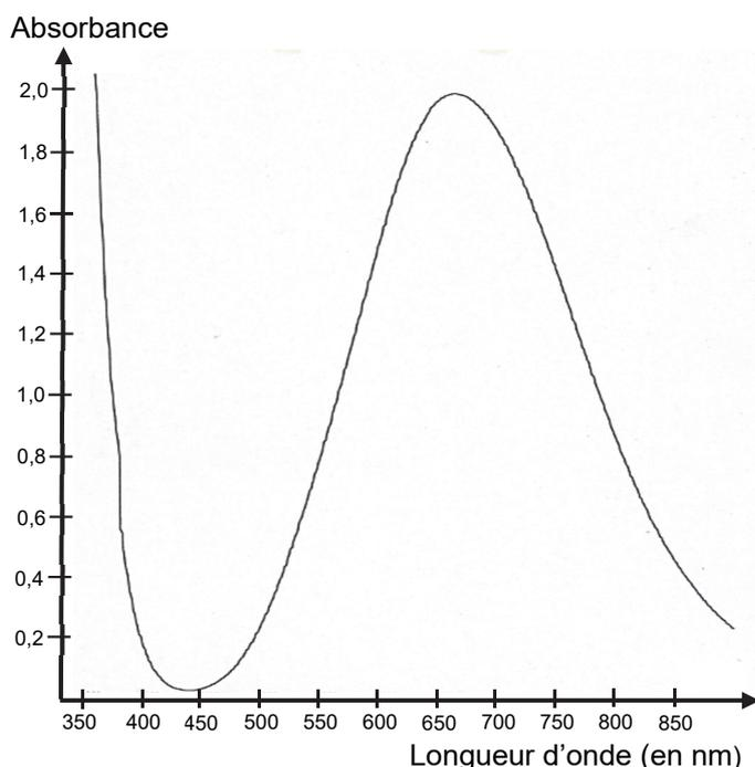
Figure 1. Spectre d'absorption de la liqueur de Fehling
